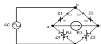
$$Z_1 = R_1 - \frac{j}{\omega C_1} ; \quad Z_2 = R_s - \frac{j}{\omega C_s} ; \quad Z_3 = R_3 ; \quad Z_4 = R_4$$
