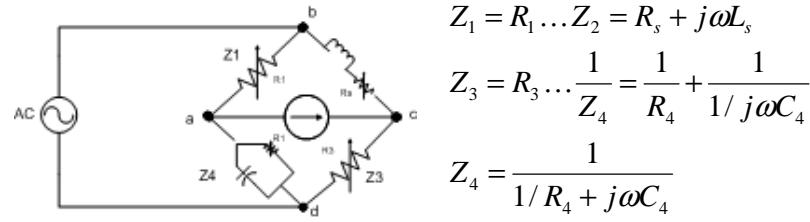
$$R_1 R_3 = \frac{R_s + j\omega L_s}{1/R_4 + j\omega C_4} \quad \frac{R_1 R_3}{R_4} + j\omega R_1 R_3 C_4 = R_s + j\omega L_s$$
