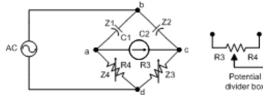
$$Z_1 = \frac{-j}{\omega C_1} ; \quad Z_2 = \frac{-j}{\omega C_s} ; \quad Z_3 = R_3 ; \quad Z_4 = R_4$$
